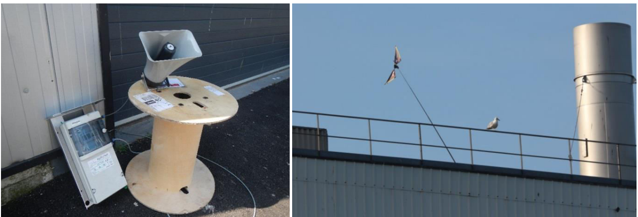
Figure 8 : Appareil sonore d'effarouchement installé sur l'entreprise ANIRI France (à gauche) et épouvantail (à droite) – Photos TBM environnement
